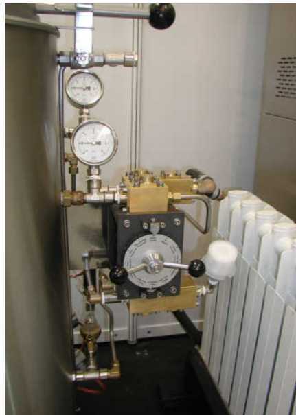
Abb. 2: Links: Prototyp der zweiten Generation des Autoklaven in einem regionalen Krankenhaus in Eikwe (Ghana).
